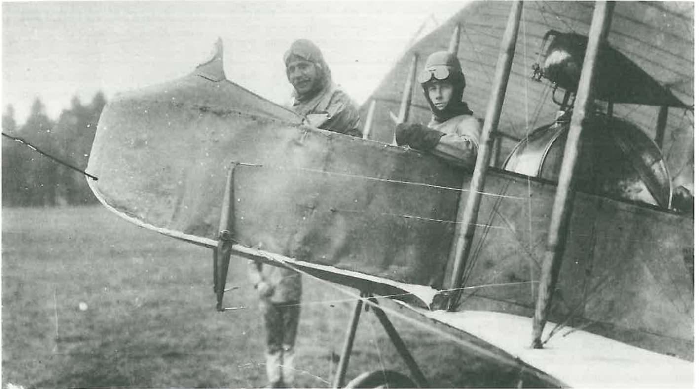
Löjtnanterna Silow och Kugelberg färdiga till start med ett Farmanbiplan där motor och propeller sitter bakom flygförarna.
